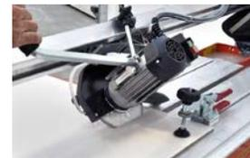
**Motor:** motor de 1,4 Kw com disco específico para grés porcelanato.
