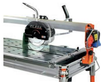
**Cabeça de corte:** A cabeça de corte desliza horizontalmente e pode se bloqueada na altura pretendida.
