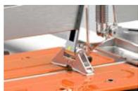
**Corte:** equipado com uma parte em borracha para evitar danos nas peças. Ímã posicionado no pé permite realizar todo o corte com um só movimento. Depois de levantar a pega, o pé está pronto para efetuar a separação do ladrilho.
